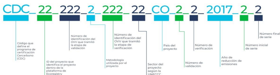
Figura 4. Descripción de los componentes del serial asignado a cada CARBONCER
